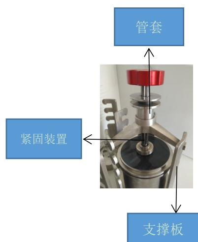
左手向上托起管套，右手顺时针旋转红色手柄，拧紧后放下管套，稍微再用力旋转红色手柄，当听到管套下落时“啪”的声音即完成研磨罐的紧固。此时研磨罐是不能旋转的，可以检查一下研磨罐的紧固情况。
