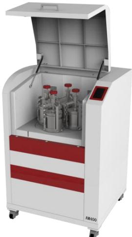
2、仪器接通电源时，控制面板可以工作，控制面板为触摸屏，点击面板上的方形按钮，门锁开启，仪器顶盖可以打开。
